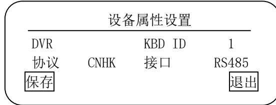
【图例 3-8 设置 485 控制 DVR 的参数】
